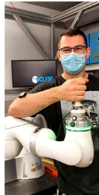
Maciej Bednarczyk, ingénieur de recherche, spécialiste en robotique, interagit avec un robot collaboratif pendant que des capteurs électromyographiques permettent d'analyser son activité musculaire, ceci afin d'adapter la commande du robot.
