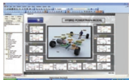
Interface utilisateur du "Prototype Virtuel Fonctionnel" d'une motorisation hybride réalisée en collaboration avec l'ENSPS. Ce prototype virtuel permet d'étudier très tôt dans le cycle de conception différents choix technologiques en vue d'optimiser le rendement (la consommation) et la pollution. Il est possible de mettre au point les algorithmes de contrôle complexes mais réalistes et de les valider avant même d'avoir accès à une maquette réelle.
