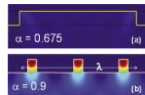
Simulation thermique d'un transistor CMOS 45 nm lors du recuit laser.
